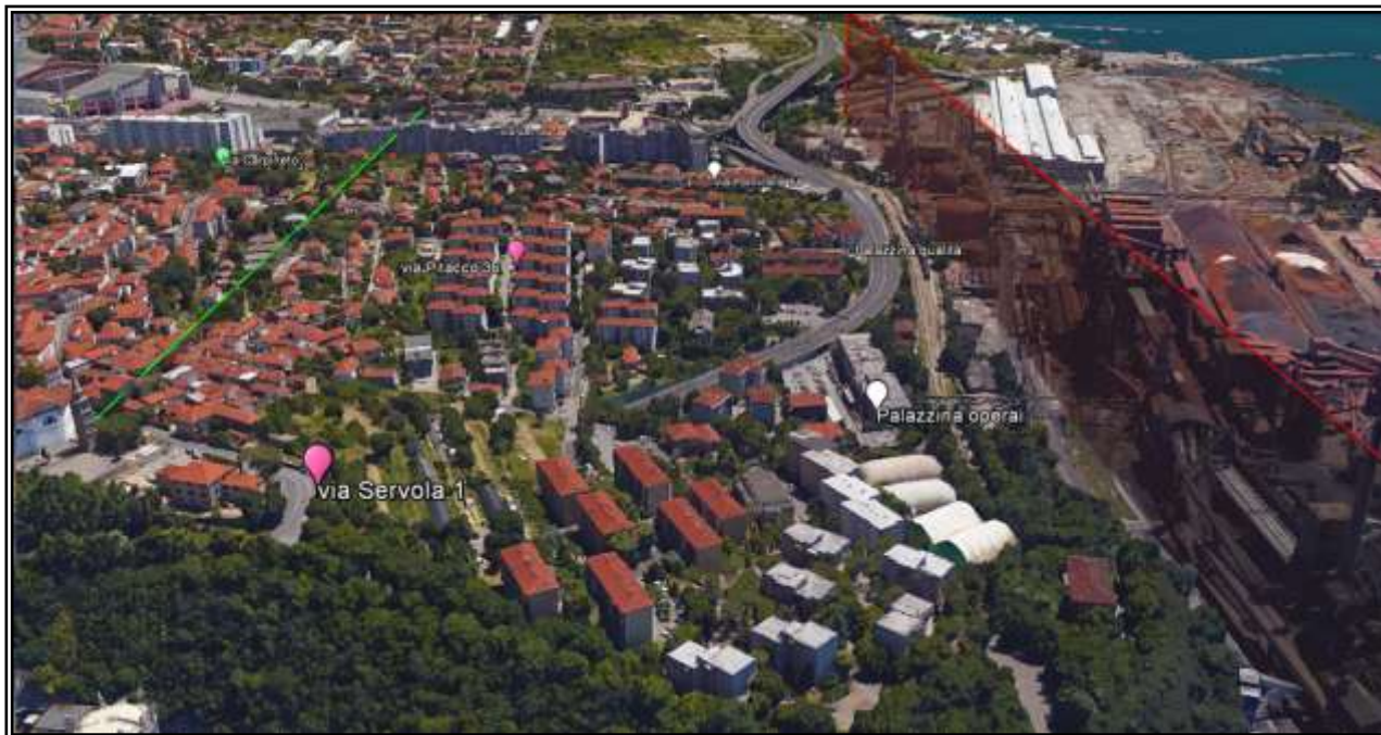
Figura 7 Sulla destra in rosso il confine degli impianti e sulla sinistra in verde la linea immaginaria dal campanile alla risiera a circa 400 metri dal confine rosso. Tra le due linee l'area di maggior ricaduta. L'altezza delle frontiere in figura è proporzionale alle quantità di polveri.
