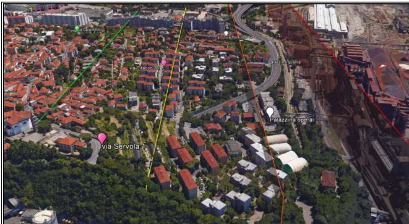
Figura 8 Al centro la linea arancione con valori di ricadute pari al 50% di quelle registrate sulla linea (rossa) di confine; e la linea gialla a cui compete un valore di 25%. L'altezza delle frontiere in figura è proporzionale alle quantità di polveri.
