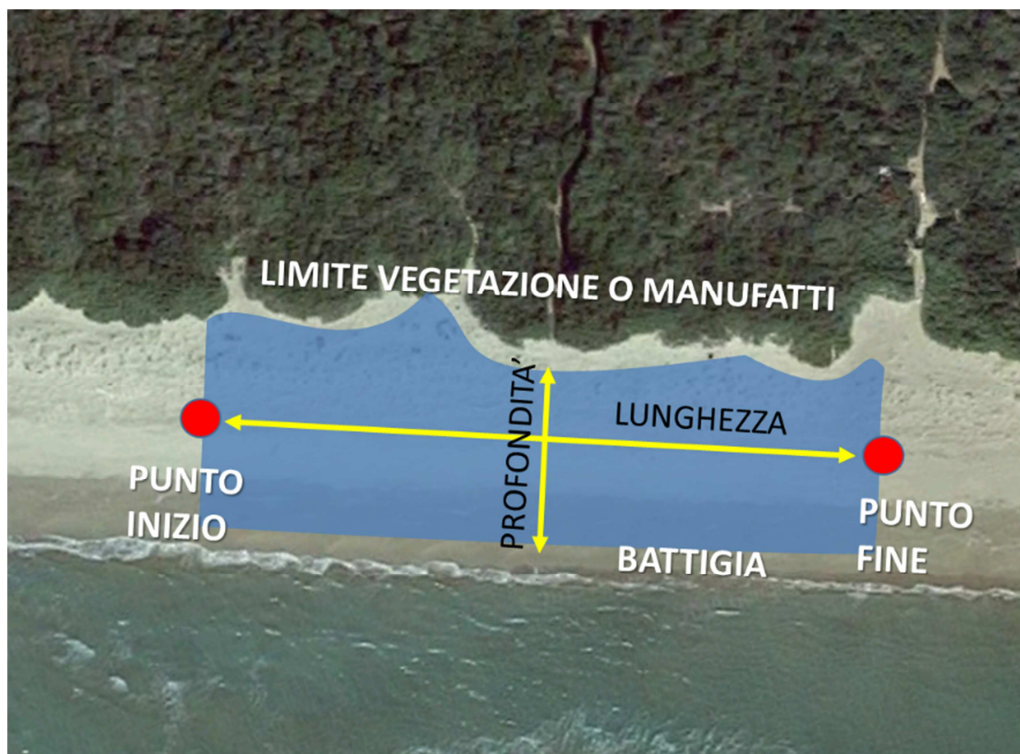
Fig. 2 – Posizionamento e misurazione del transetto (area in blu). In giallo la misurazione della lunghezza; e della profondità (ampiezza). I punti rossi indicano i punti di Inizio e Fine transetto che devono essere georeferenziati.
