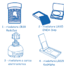
Fig. 1 - Rivelatori passivi per la misura del radon
