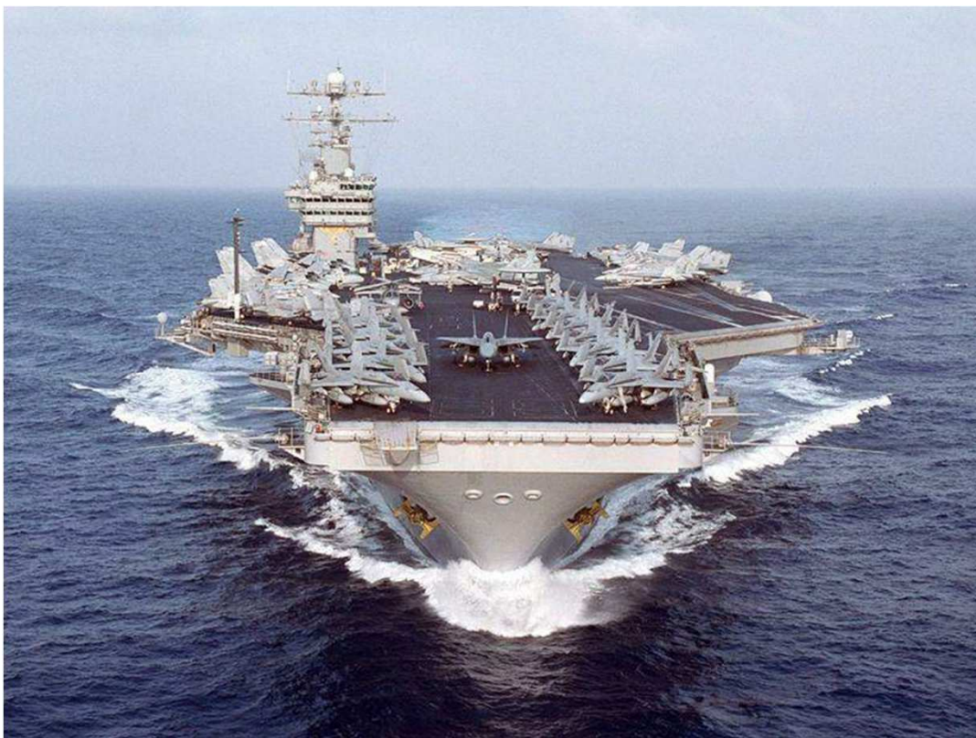
PORTAEREI USS Dwight D. Eisenhower (CVN 69) Propulsione: due reattori nucleari Westinghouse A4W Potenza totale: 194 MW Lunghezza: 330 metri Ultima sosta a Trieste: primavera 2000
