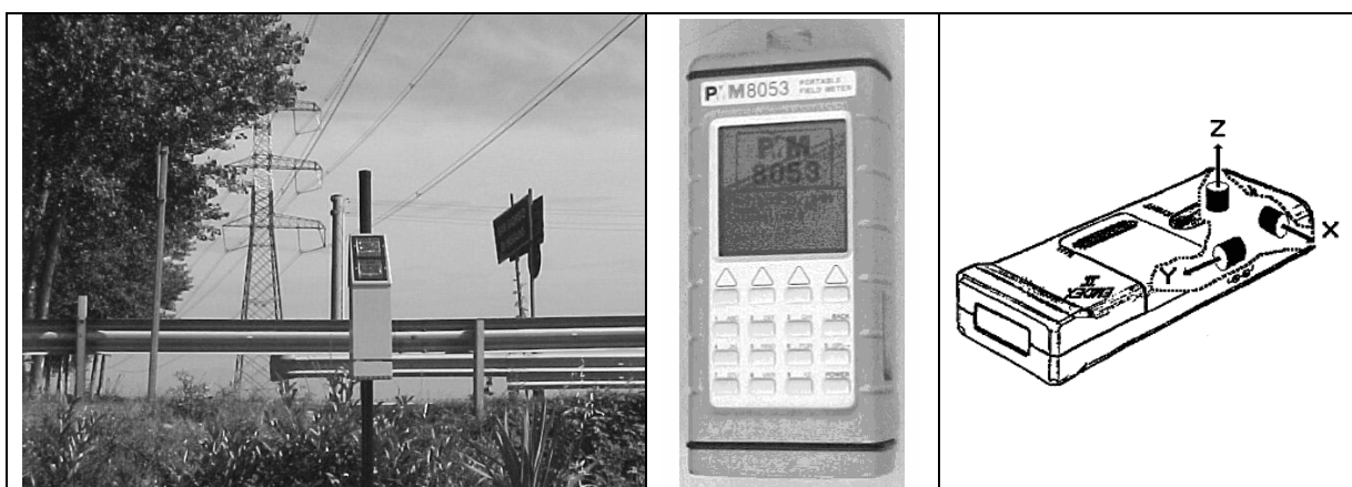
Figura 2.a: centralina per il monitoraggio continuo PMM8055S
