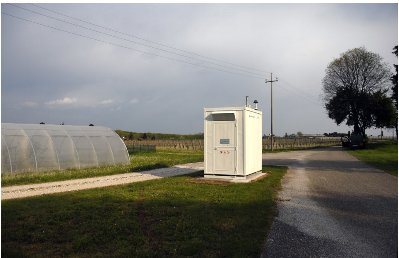
Fig. 8 - Centralina per la misurazione della concentrazione di ozono di S. Osvaldo (UD) (Fonte: foto archivio ARPA FVG)
