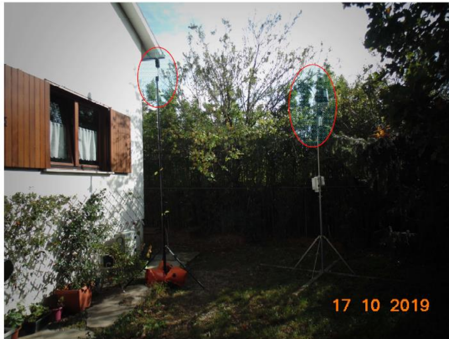
Ricettore: postazione fonometrica in ambiente esterno, con microfono posto all'altezza di 4 metri, ad un metro dalla facciata più esposta (e posizionamento meteo)
