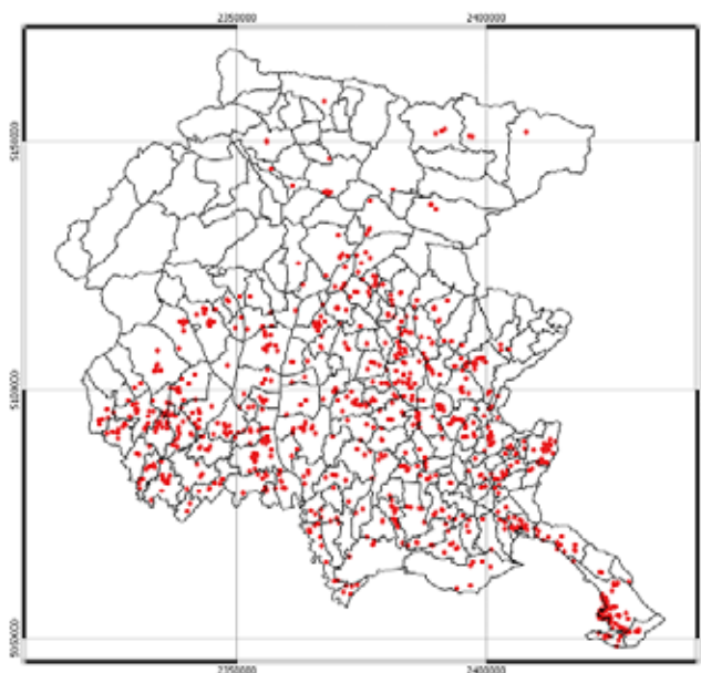
Figura 2: mappatura delle coperture in cemento amianto condotte da ARPA FVG nel 2006, 2007 e 2015 (circa 1500 strutture pari a una superficie complessiva > 2 300 000 m 2 ).
