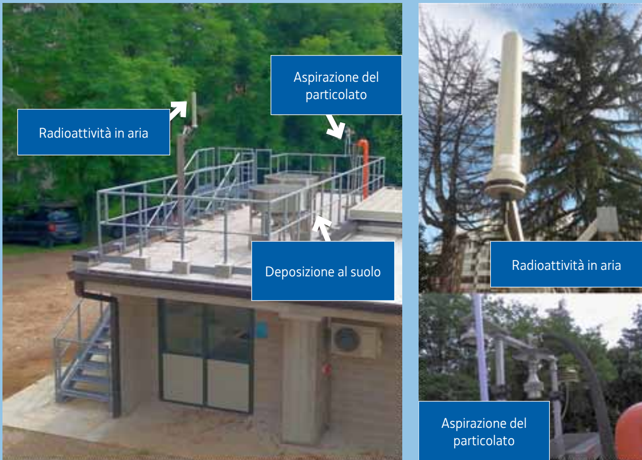
Figura 1: stazione ARPA FVG per la misura di irraggiamento, per la raccolta del particolato atmosferico e della deposizione al suolo.
