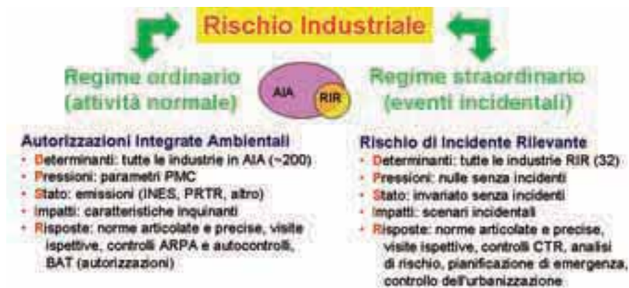
FIGURA 1. SCHEMA LOGICO DI AUTORIZZAZIONE INTEGRATA AMBIENTALE (AIA) - RISCHI DI INCIDENTE RILEVANTE (RIR) SECONDO IL MODELLO DPSIR.
