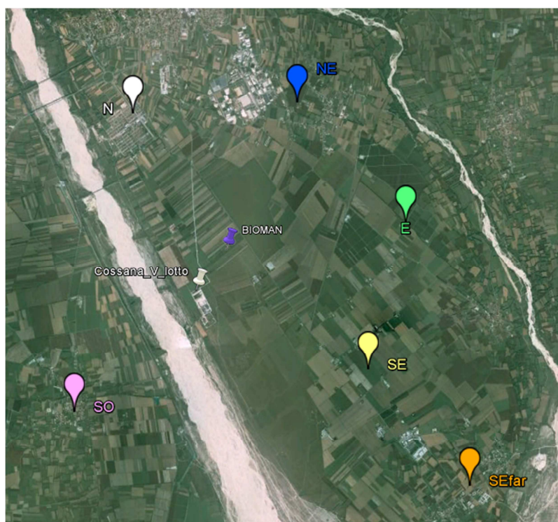
Figura 10: per ciascun gruppo viene calcolata una postazione fittizia ottenuta dal baricentro dei recettori che formano il gruppo. Il baricentro viene calcolato pesando le coordinate di ciascun recettore per il numero delle ore di controllo.
