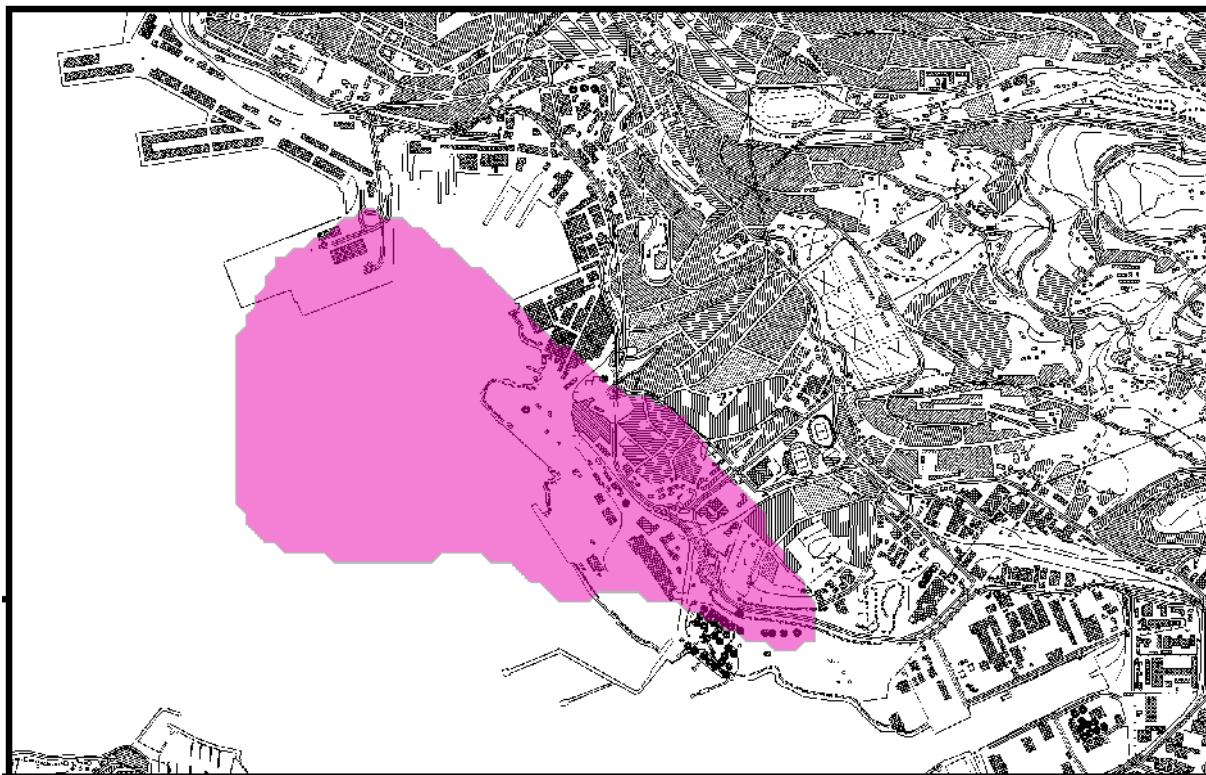
Figura 32. Andamento delle concentrazioni medie annue di benzo[a]pirene nell'anno 2012 nei pressi della cokeria dello stabilimento siderurgico di Servola stimate utilizzando simulazioni numeriche delle emissioni derivanti dalla cokeria, ricalibrate in funzione dei valori osservati al suolo mediante stazioni fisse (e.g., stazione RFI di San Lorenzo in Selva)
